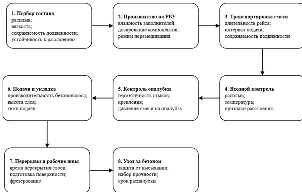
Рис. 1. Организационно-технологическая схема применения СУБС при возведении монолитных конструкций
