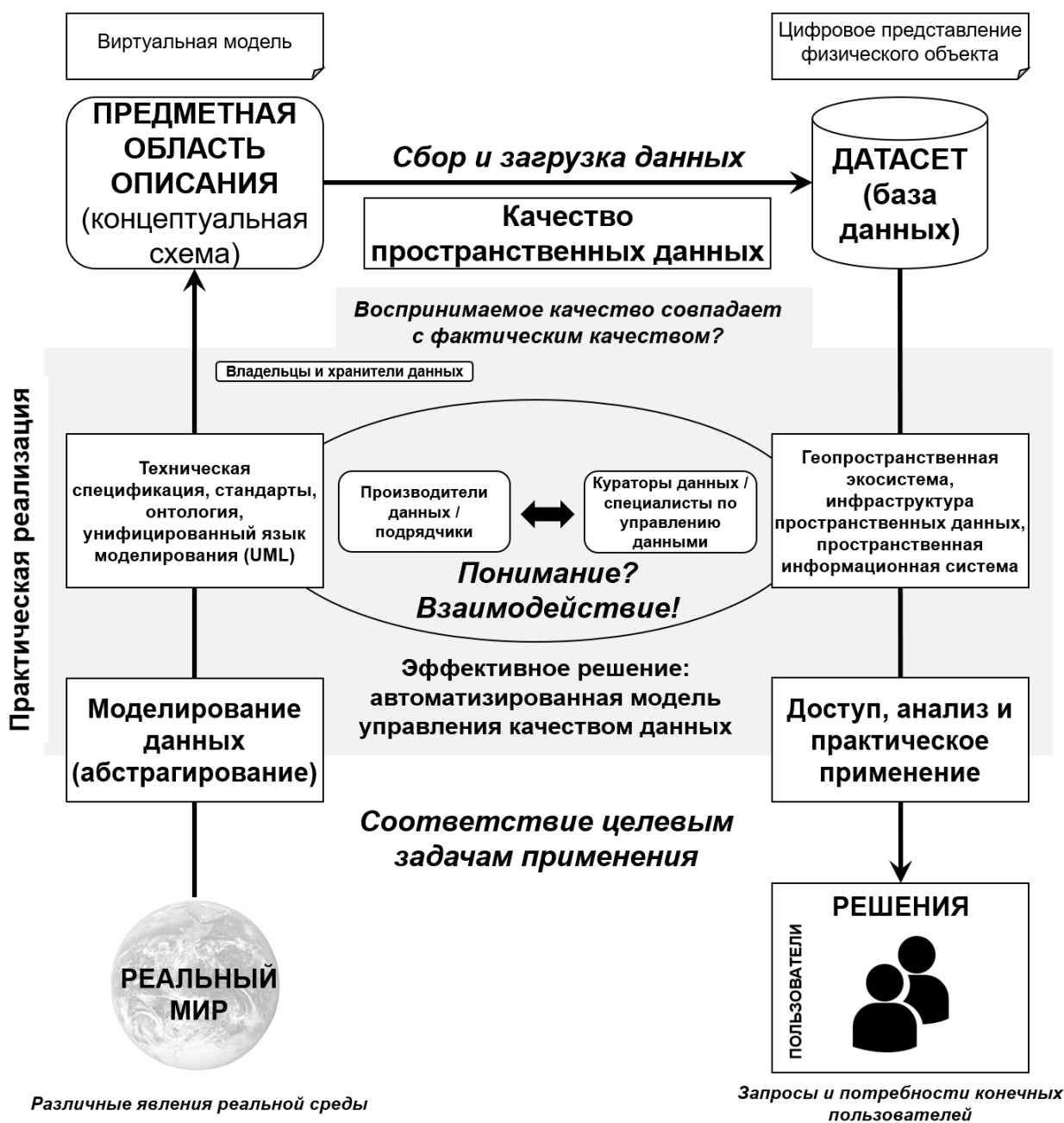
Рис. 1. Модель автоматизированного управления качеством данных (DQM)
