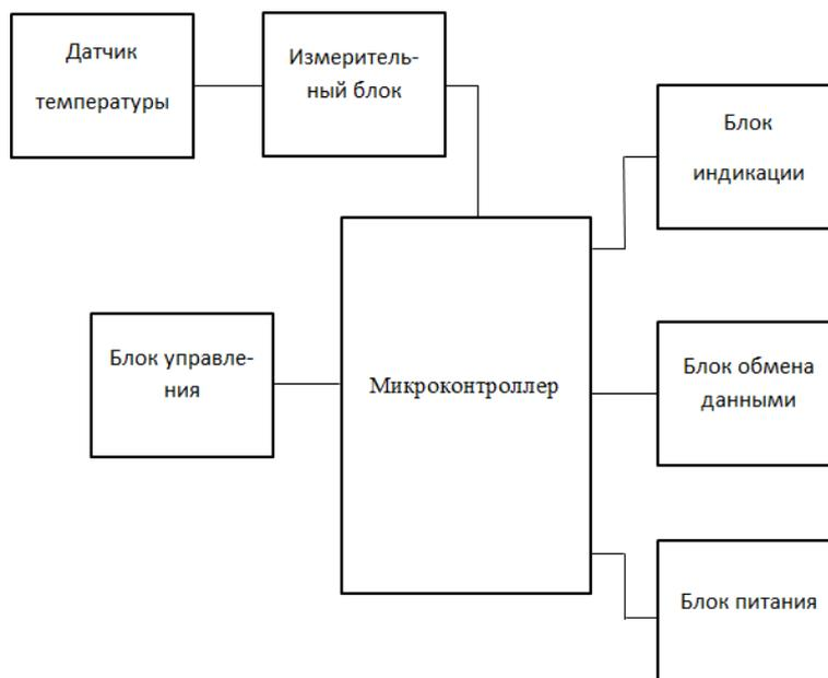
Рис. 1. Структурная схема измерителя-регулятора температуры
