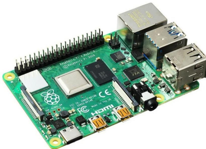
Рис. 1. Компьютер *Raspberry Pi 4*
