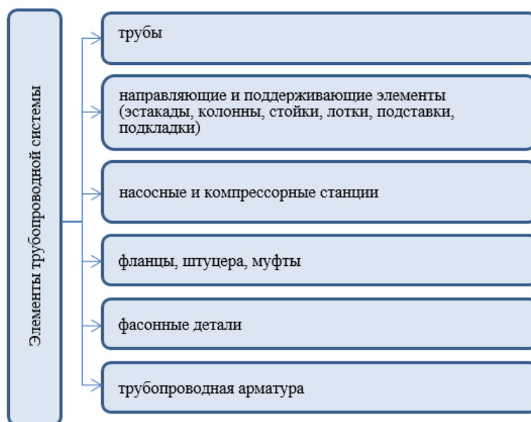
Рис. 1. Элементы трубопроводной системы
