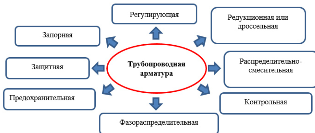
Рис. 2. Виды трубопроводной арматуры
